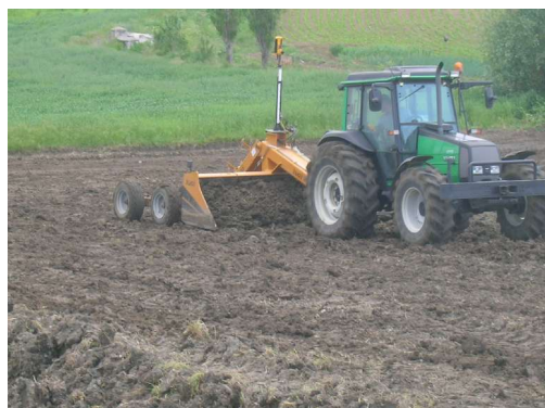
En Turquie, l'engin tracté est utilisé pour niveler les terrains de riziculture. Il faut le coupler avec un radar situé à l'extrémité du champ. La niveleuse détermine alors automatiquement sa hauteur de rabotage.
